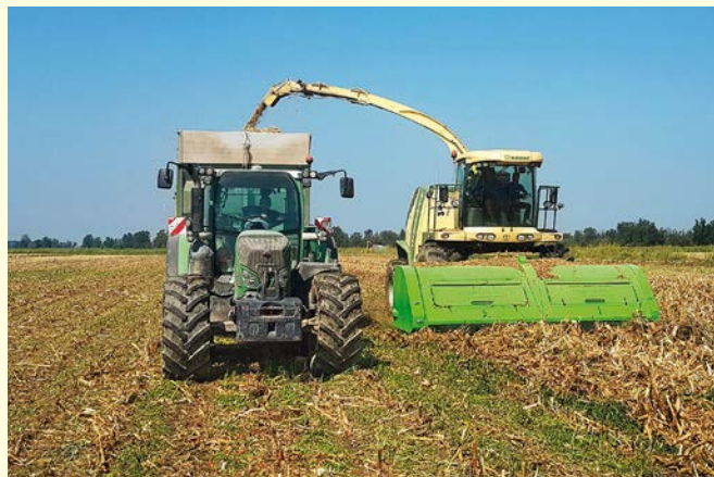
Cantiere B: trincia-caricatrice dotata di testata trinciante
