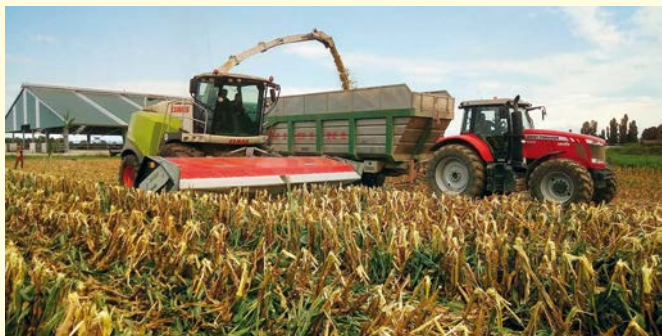
Cantiere A: trincia-caricatrice dotata di testata da taglio «whole-crop»
